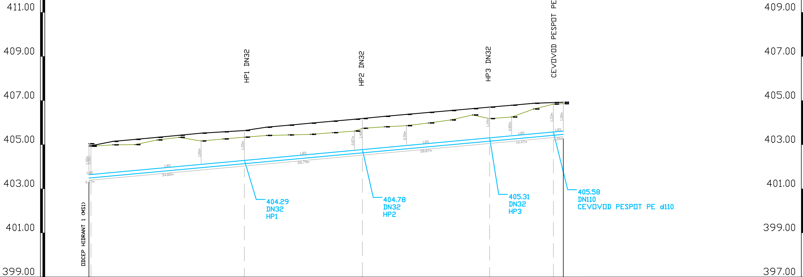
CEVODVOD STANETOVA CESTA DUKTIL DN150 M 1:500/100 M1.K1
